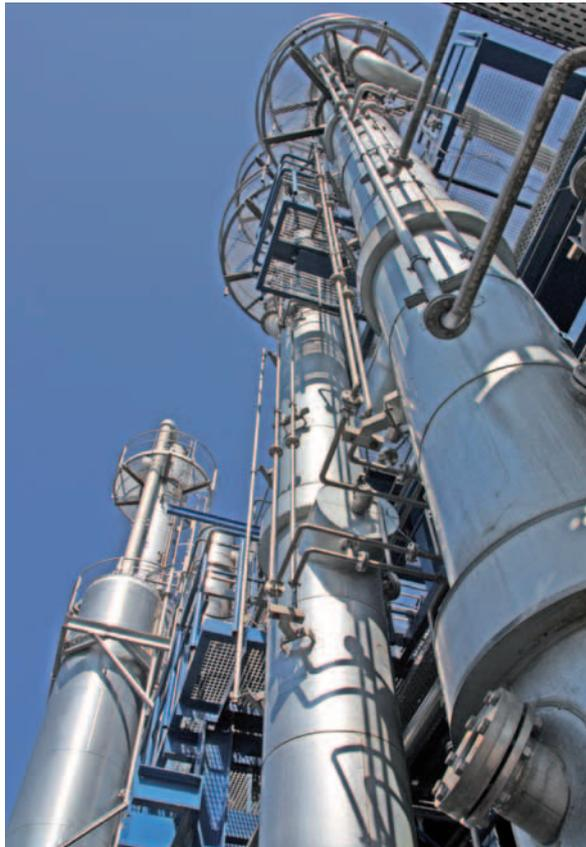
Die hohen Destillationskolonnen sind das Markenzeichen von Richard Geiss, hier werden die Lösemittel aufbereitet.
