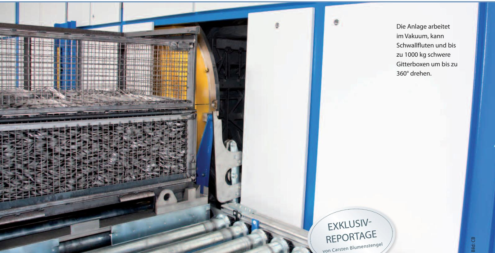
Die Anlage arbeitet im Vakuum, kann Schwallfluten und bis zu 1000 kg schwere Gitterboxen um bis zu 360° drehen.
