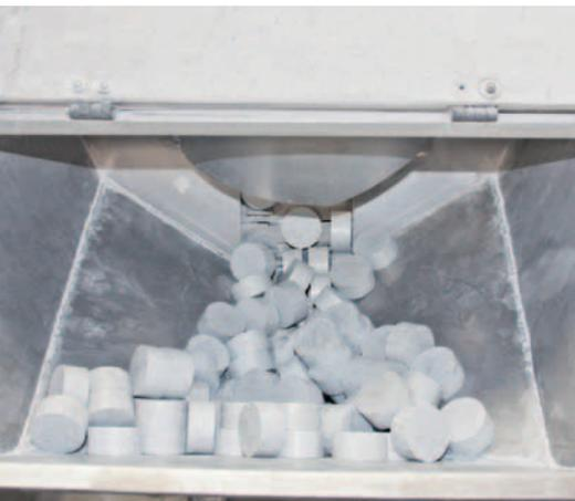
Aluminiumrohlinge, aus ihnen werden nach dem Fließpressen Kolben für Bremszangen.
