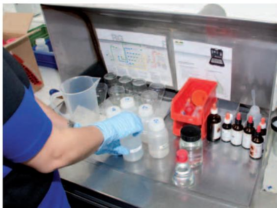
Die Lösemittelqualität wird bei alutec täglich bei allen Maschinen geprüft. Auf diesem Weg können Änderungen schnell erkannt werden.
