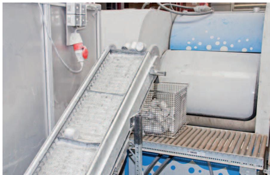
Linienorientiert Reinigen: Die Bremskolben fallen nach dem Fließpressen direkt in den Reinigungskorb und gelangen über eine Rollenbahn in die dahinter platzierte wässrige Reinigungsanlage.
