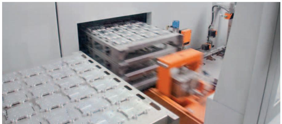
Immer häufiger kommen Aluminium-Kühlkörper für Elektronik-Anwendungen im Automotive-Bereich zum Einsatz. Hier wird gerade die PER-Anlage mit einer neuen Charge automatisch beschickt.
