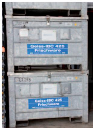
Das PER wird in Sicherheitsbehältern geliefert, um die Risiken im Umgang zu minimieren.
