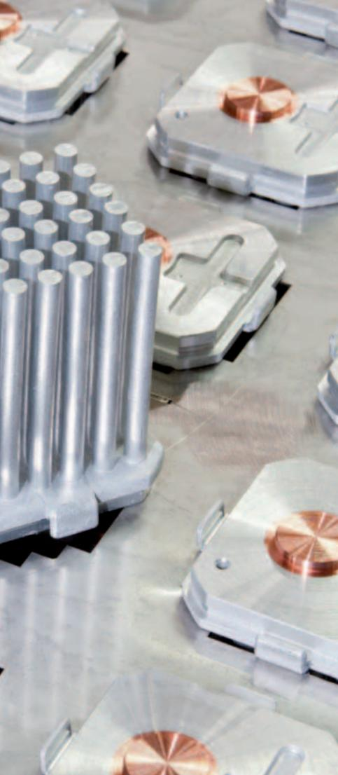
Fertigungshalle, steht eine relativ kleine Fließpressmaschine. Eine Art Trichter ist gefüllt mit etwa drei Zentimeter dicken Aluminiumscheiben mit einem Durchmesser von rund zehn Zentimetern. Aus diesem Trichter werden die Rohlinge über eine Art Rollkanal
