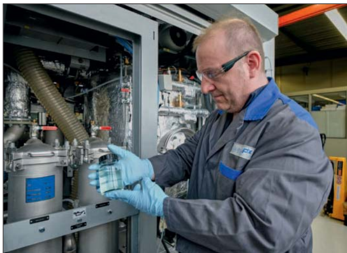
Hanspeter Oberthaler, Abteilungsleiter bei Springfix, entnimmt Lösemittelproben aus der Anlage für die Serviceanalyse im firmeneigenen Labor der Richard Geiss GmbH.
