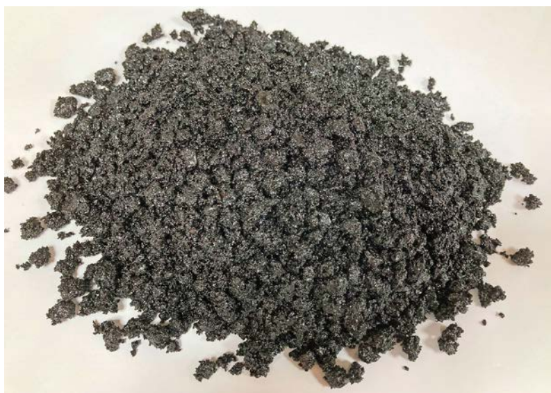
Bei der Extraktion wird das Bitumen mit Hilfe eines Lösemittels von den Gesteinskörnungen getrennt
